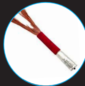
TENSILE TEST 120mm 2 cable @ 23kN
